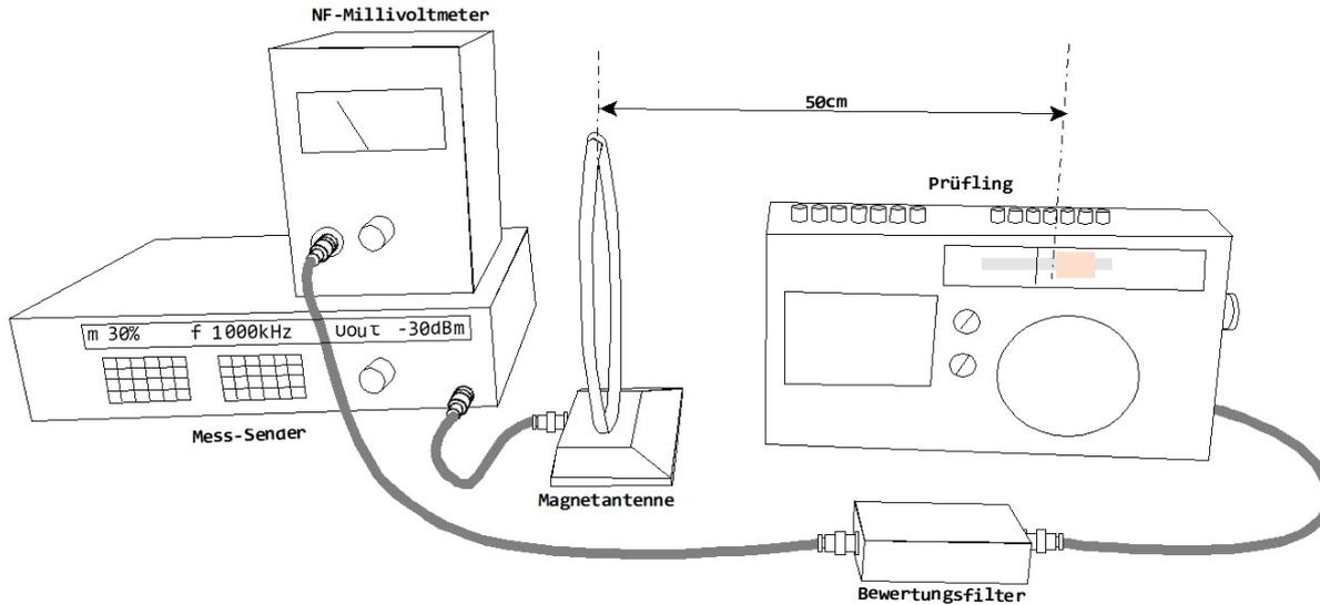
Charakteristik eines Rundfunkempfängers: Nimmt man abhängig von der Signalfeldstärke den Audio-Pegel, das Rauschen und den Klirrfaktor auf, dann erhält man das folgende Diagramm. Daraus lässt sich die rauschbegrenzte Empfindlichkeit ablesen. Sie ist dann erreicht, wenn das Signal-Rauschverhältnis (SNR) den spezifizierten Wert von 26dB erreicht hat. Datenblattabhängig sind auch 10dB oder 20dB möglich.
